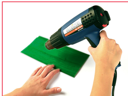
Schritt 2 | Schmelzen Sie das abgeriebene Wachs mit einem Fön, sodass die Oberfläche des Papiers gut versiegelt wird. (Achtung: Ein Zuviel an Wachs kann sich auf die andere Seite des Papiers hindurchsaugen)
