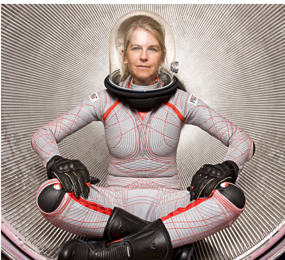
Abb 2 | Raumanzug im Teststadium: Bio Suit. (Quelle: NASA)
