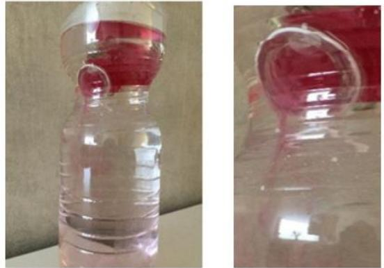
*Abbildung 7: Einleiten von kaltem Wasser am oberen Ende eines großen Warmwasserbehälters (Quelle: ESA CCI)*
